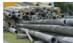
再生処理前のコンクリート柱
