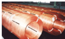
再生された電線
