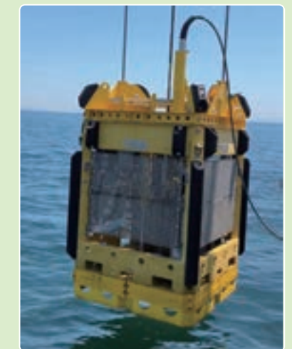
海底地盤調査機器 Manta-200(Geomil社) (Cone Penetration Testing System)
