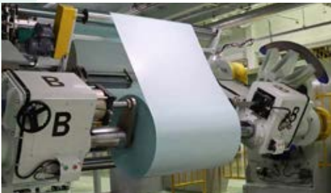
無溶剤型剥離紙用の塗工設備（熊谷工場）
