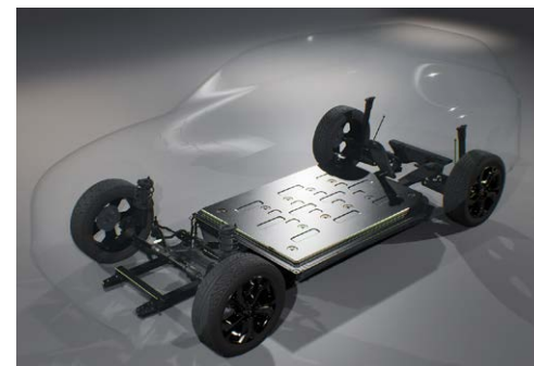
マツダ独自開発のBEV専用プラットフォーム（イメージ図）
