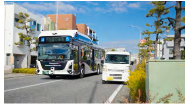
自動運転による路上駐車回避を検証
