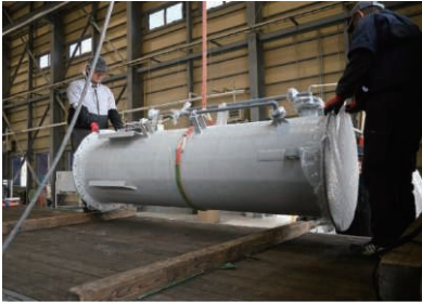
工場で製作したFRPの製品「ミストセパレーターケーシング」の出荷風景
