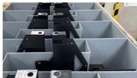
（改善後）再利用可能なコンテナに格納された部品
