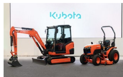
電動建設機械と電動トラクタ
