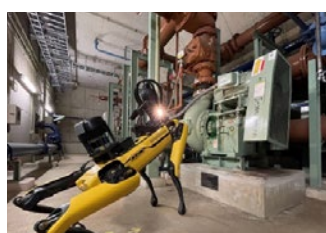
四足歩行ロボットがメーターの値から点検データを自動で取得している様子
