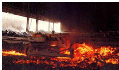
製鉄所のノロ処理を行うラジコンブルドーザー(D125AR)
