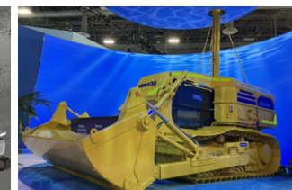
水中施工ロボット
