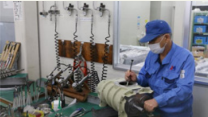
ポンプオーバーホールの様子
