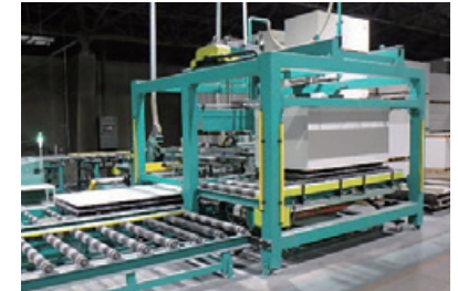
(株)エーアンドエー茨城 面取機設備
