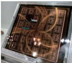
*510×515mmサイズのパネル チップ埋め込みインターポザー
