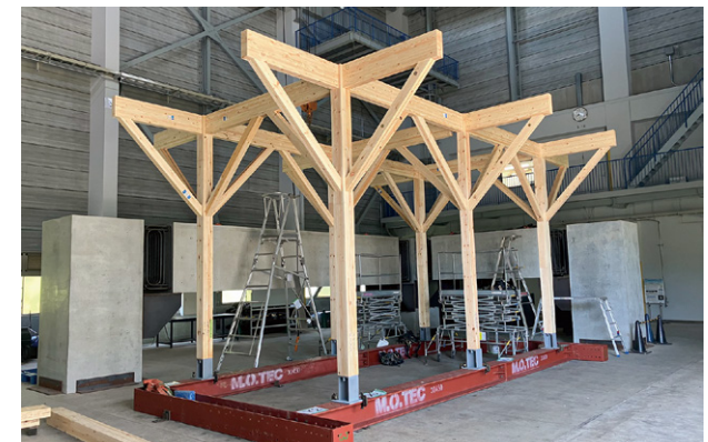
木材と鋼材を組み合わせた駅ホーム上家の試験状況 (写真協力:JR東日本、ポラス暮らし科学研究所)
