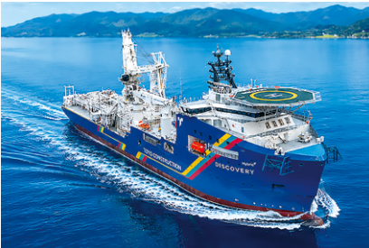
2026年6月完成 自航式ケーブル敷設船「DISCOVERY」 国内最大級となる9,000tのケーブルタンクを搭載。今後、市場の成長が期待される洋上風力発電施設等での幅広いケーブル工事需要に対応。
